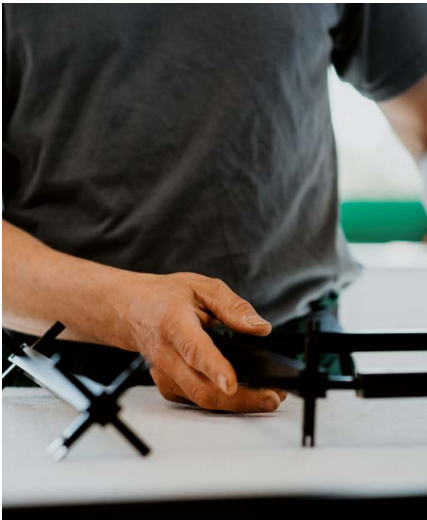
Das Regalsystem besteht aus schwarz eloxierten Aluminium-Profilen, die über Verbindungsknoten miteinander verschraubt werden
