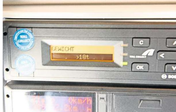
Ein „On-Board-Unit“ genanntes Gerät im Lkw erledigt die automatische Abrechnung der Maut.
