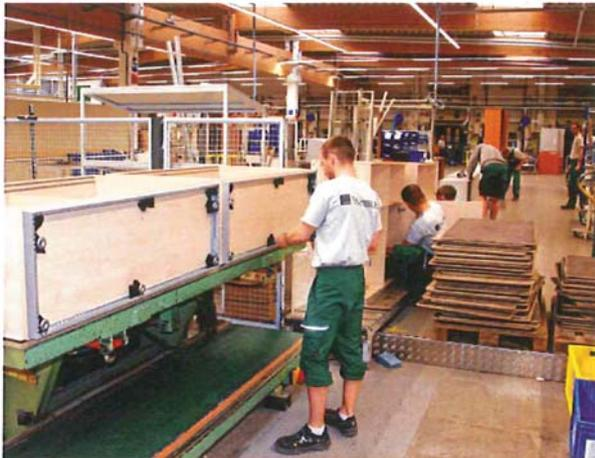
Nachdem aus den riesigen Spanplatten kleine Teile in einer Presse verleimt wurden, übernehmen Arbeiter die manuelle Endproduktion und montieren beispielsweise Metallfüße an den Schränken.
