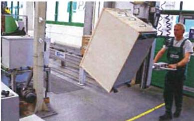
Durch Unterdruck werden die fertigen Möbel angesaugt und lassen sich so leichter für den Transport vorbereiten. FOTOS: THOMAS STENGL
